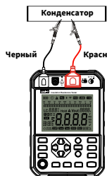
Рис. 9.3.3.1 Проводное подключение измерения емкости
