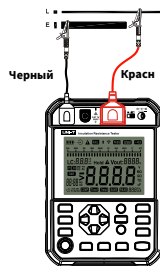
Рис. 9.3.2.1 Проводное подключение измерения напряжения
